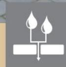
Versickerung durch die Fuge
