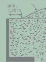
**B** | Böschung Geländeneigung  $20^\circ$ , Verkehrslast bis  $p = 5 \text{ kN/m}^2$ , Abstand: 1,2 m (bis 155 cm Höhe)/1,5 m (ab 180 cm Höhe)
