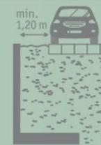
**A** | Verkehrslast bis  $p = 5 \text{ kN/m}^2$  ohne Anpralllasten, Abstand: 1,2 m (bis 155 cm Höhe)/1,5 m (ab 180 cm Höhe)
