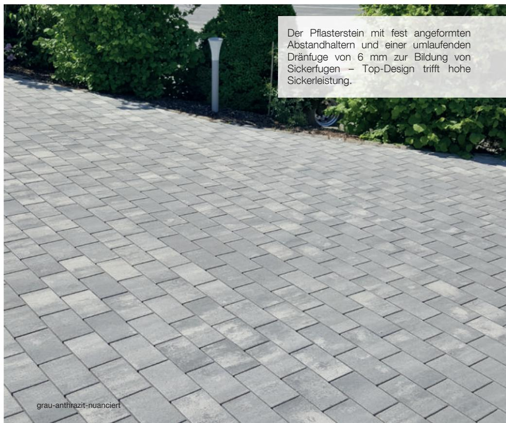
Der Pflasterstein mit fest angeformten Abstandhaltern und einer umlaufenden Dränfuge von 6 mm zur Bildung von Sickerfugen – Top-Design trifft hohe Sickerleistung.
