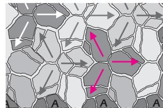
Einfache Verlegung der Basissteine: Aufgrund der sechseckigen Polygonalform wird jeder Stein um 120° (links oder rechts herum) zum Nachbarstein hin gedreht.
