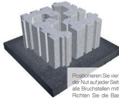
Positionieren Sie vier Passsteine mit jeweils der Nut auf jeder Seite nach außen, so dass alle Bruchstellen mittig nach innen zeigen. Richten Sie die Basissteine grob an den jeweiligen Außenkanten aus.
