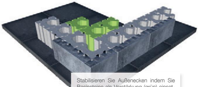
Stabilisieren Sie Außenecken indem Sie Basissteine als Verstärkung (grün) einsetzen. Verbinden Sie diese mit den mitgelieferten Steckverbindern.
