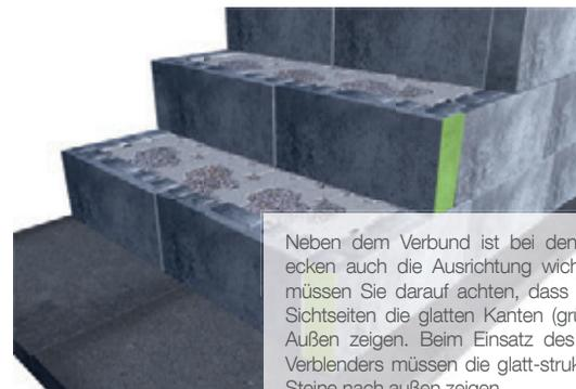
Neben dem Verbund ist bei den Außen-ecken auch die Ausrichtung wichtig. Hier müssen Sie darauf achten, dass bei allen Sichtseiten die glatten Kanten (grün) nach Außen zeigen. Beim Einsatz des Quada-Verblenders müssen die glatt-strukturierten Steine nach außen zeigen.
