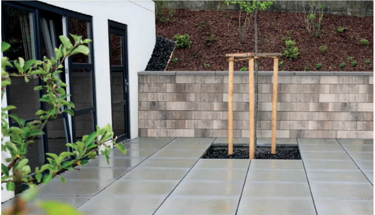
Richtig aufgebaut und verfüllt, ermöglicht Ihnen die Tribus® - Mauer, Hänge und Böschungen bis in große Höhen abzufangen. Beachten Sie hierbei immer die Bodenbeschaffenheiten vor Ort und ziehen Sie einen Statiker zu Hilfe. Aufbauten geringer Höhe (bis zu einem Meter) können in der Regel ohne statischen Nachweis errichtet werden.
