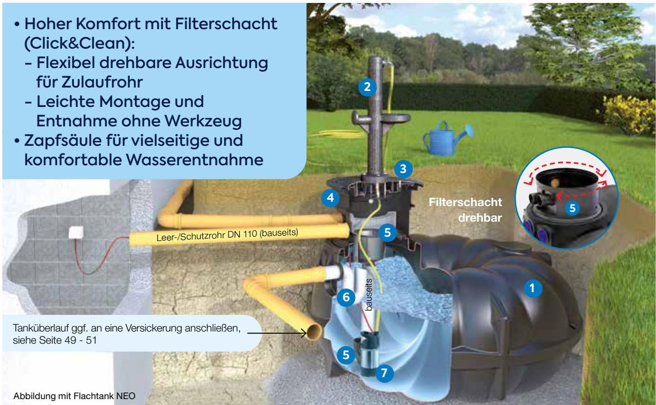
Tanküberlauf ggf. an eine Versickerung anschließen, siehe Seite 49 - 51
