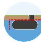
**NEO Standard:** Grundwasserstabil bis **Tankmitte**
