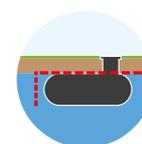
**NEO Standard:** Grundwasserstabil bis **Tankmitte**
