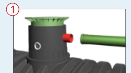
Flexibler Anschluss bis DN 400 möglich
