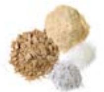
Der Unterschied zu GCC HOLZart liegt bei GCC HARZart darin, dass ein Teil der Inhaltsstoffe durch recyceltes Kunstharz ersetzt wird. So ergibt sich ein Holzanteil von mind. 50%. Die restlichen 50% ergeben sich aus dem Kunstharz, den Polymeren und den Additiven. Der Kunstharzanteil verleiht dem Werkstoff seinen Namen.
