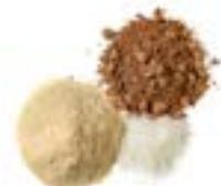
Dieser polymergebundene Holzwerkstoff besteht aus bis zu 75 % Holzfasern. Diese werden zerkleinert und im trockenen Zustand mit Polymeren (recycelter Kunststoff) und Additiven (Bindemittel und Farbe) vermischt. Die eingesetzten Polymere dienen dabei als „Klebstoff“ und halten die Naturfasern zusammen.
