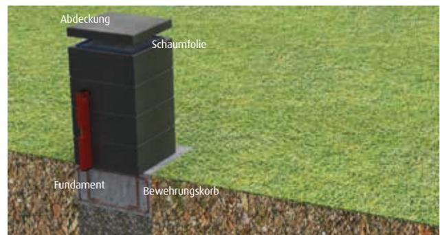
Der Beton der oberen Schicht wird leicht erhöht dachförmig eingebracht und danach die Pfeilerabdeckung aufgesetzt. Der Füllmengenbedarf kann separat angefordert werden.
