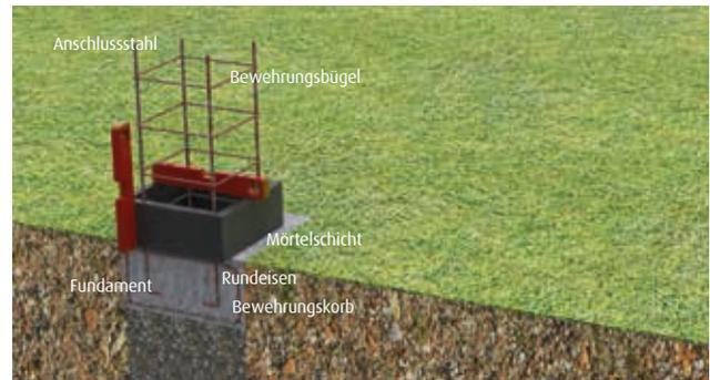
Die erste Schicht der Elemente muss absolut fluchtrecht und waagrecht in eine Zementmörtelschicht verlegt werden (hiernach ist eine Ruhepause ratsam).
