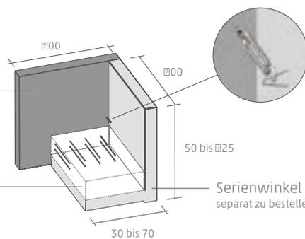
Verbindung der Dicke durch mitgeliefertes Spannelement
