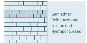
Hier werden die Lagen so geliefert, dass jede 7. und 8. Reihe in der Steinbreite von 15 cm verlegt wird.
