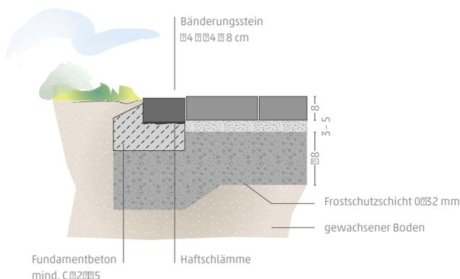
Bänderungssteine als Abgrenzung werden etwas tiefer als der Flächenbelag in einem Betonfundament eingebaut. Würden sie in genau der gleichen Höhe eingebaut, können die Steine beim Abrütteln der Pflasterfläche Schaden nehmen.
